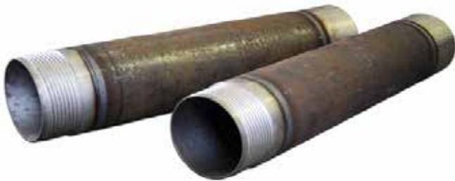
La nostra gamma di Tubi di Rivestimento viene realizzata attraverso la saldatura dei manicotti in acciaio 42CrM04 ad un tubo intermedio in materiale N80. I manicotti inoltre, sono sottoposti ad un processo di nitrurazione, al fine di garantirne un'ancora maggiore resistenza all'usura del filetto. La certificata qualità degli acciai utilizzati, abbinata all'efficiente processo produttivo, ci permette di offrire ai nostri clienti le migliori prestazioni di prodotto presenti sul mercato.
