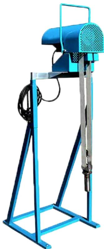
Installato sopra un pozzo o un piezometro di almeno 50 mm di diametro, lo skimmer della cinghia estrae la fase galleggiante surnatante nella struttura. Lo scrematore è composto da una banda oleofila su cui aderiscono idrocarburi e oli. Deve essere posizionato perpendicolare al piezometro in modo che la banda scenda nel pozzo e la puleggia ponderata sia immersa sotto la fase flottante.
